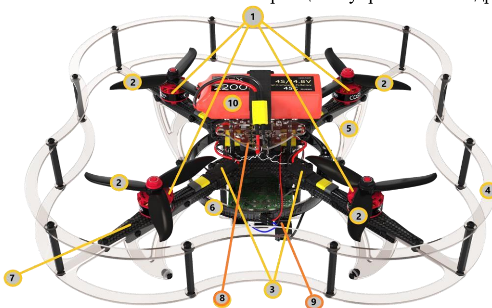
Рисунок 1. Схема квадрокоптера Clever. 1 - моторы; 2 - пропеллеры; 3 - регуляторы оборотов; 4 - защита; 5 - ноги; 6 - светодиодная лента; 7 - рама квадрокоптера; 8 - полетный контроллер; 9 - приемник, 10 - аккумулятор.
